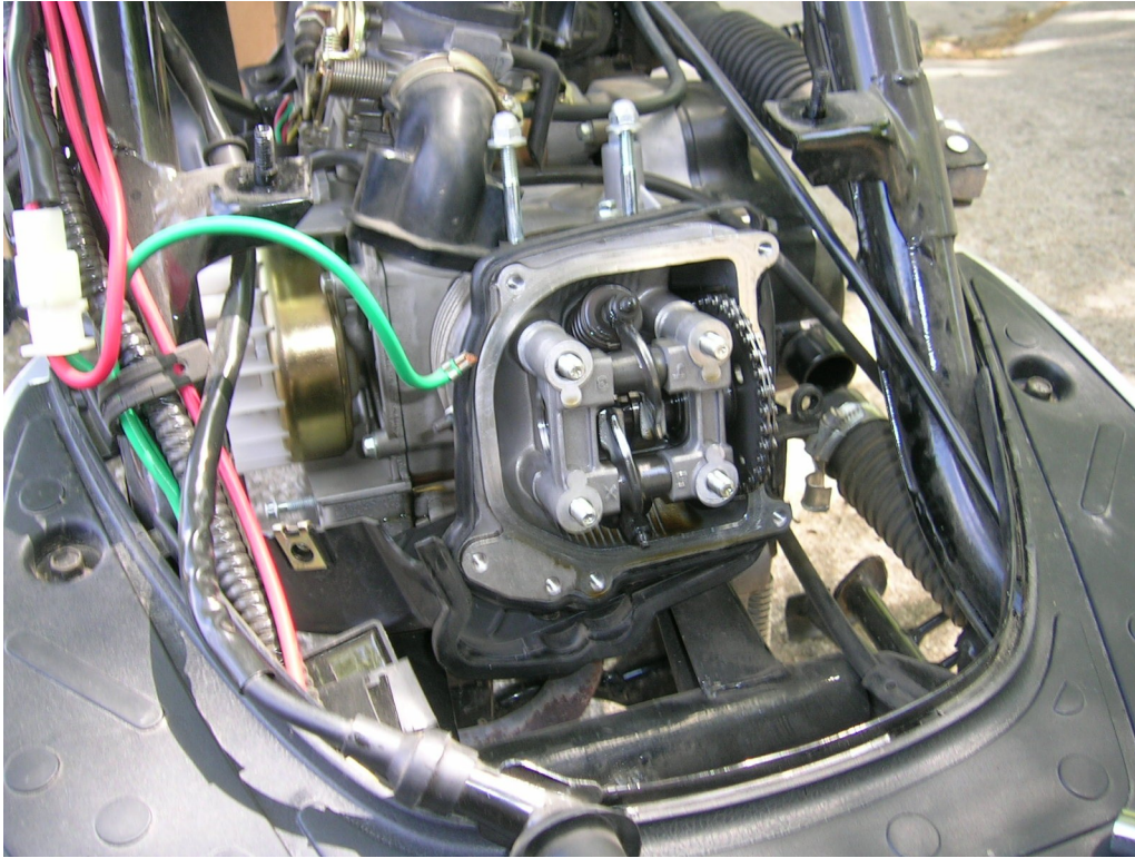
Fig. 6. Remove camshaft caps (before)
