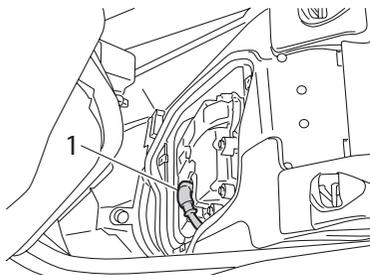
1. Наконечник свечи зажигания
