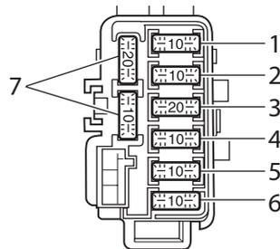
1. Предохранитель системы зажигания
