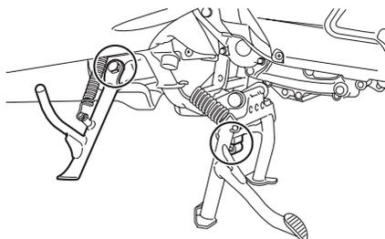
Функционирование центральной опоры и бокового упора должно проверяться перед каждой поездкой, а оси и точки контакта металлических поверхностей должны смазываться при необходимости.
