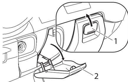
1. Рычаг открывания багажного отсека
