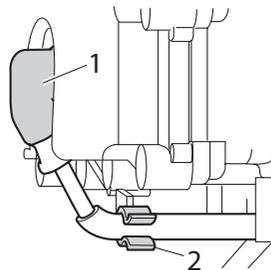
1. Наконечник свечи зажигания
