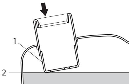
1. Заливная горловина топливного бака
