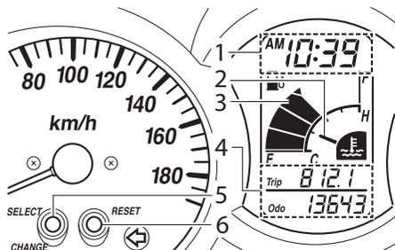
1. Часы/указатель температуры окружающего воздуха
