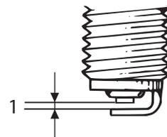
1. Зазор между электродами свечи зажигания
