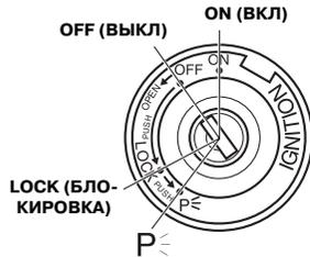
Замок зажигания/блокиратор руля включает зажигание и приборы освещения, а также используется для блокирования руля.
