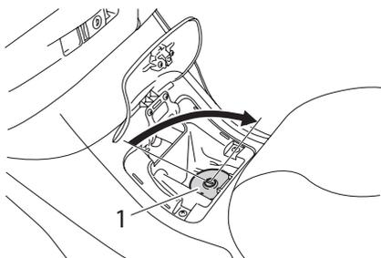
1. Пробка горловины топливного бака
