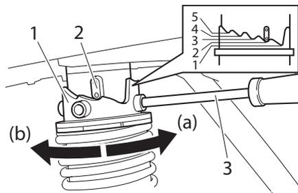
1. Регулировочное кольцо предварительного сжатия пружины
