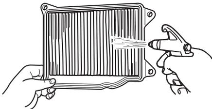
7. Проверьте фильтрующий элемент на предмет загрязнений и при необходимости замените его.
