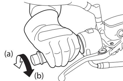
Вы можете изменять скорость, открывая или закрывая дроссельную заслонку. Для увеличения частоты вращения вала двигателя поворачивайте рукоятку акселератора в направлении (a). Для уменьшения частоты вращения вала двигателя поворачивайте рукоятку акселератора в направлении (b).
