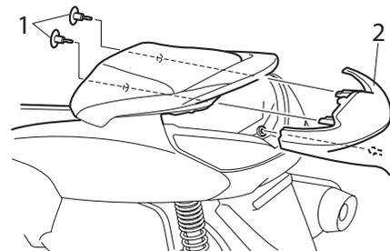
1. Фиксатор быстрого крепления
