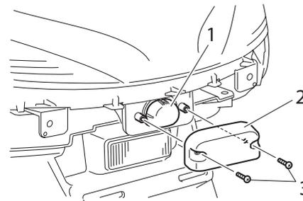
1. Рассеиватель лампы фонаря освещения регистрационного знака
