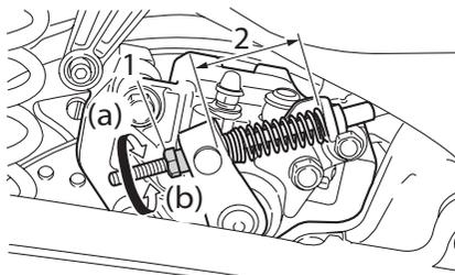
1. Регулировочная гайка
